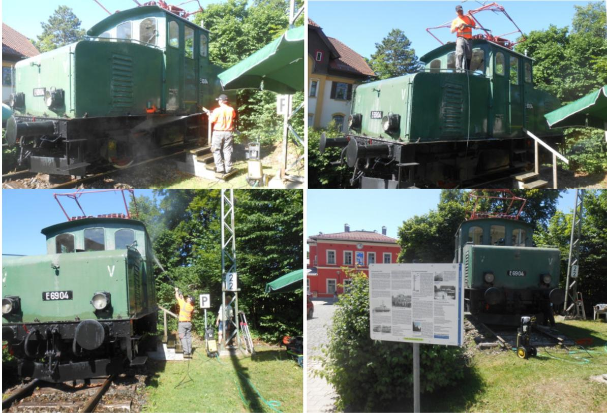
Nachdem es in der Vergangenheit über die so genannte Hochspannungs-Durchführung am Dach der kleinen Lokomotive zu einem Wassereinbruch im Führerstand gekommen war, wurde dann als Nächstes die betroffene Baugruppe ausgebaut, entrostet, lackiert und schließlich frisch abgedichtet wieder eingebaut.
