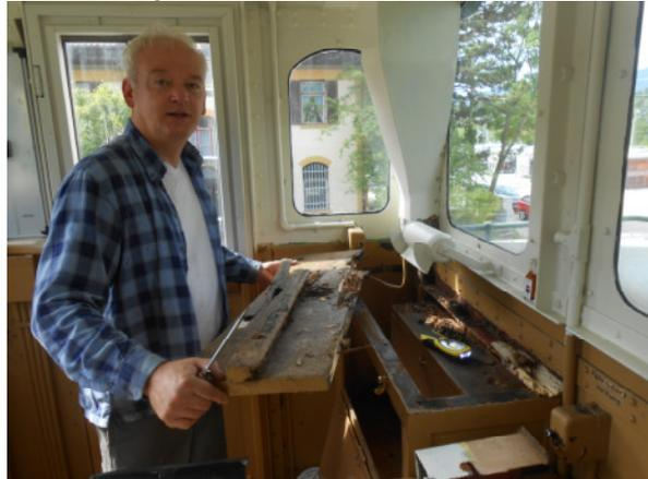
*Freilegen der Schadstelle (links) und Entfernung des verfaulten Deckbretts (rechts): S'Bredl is weg*
