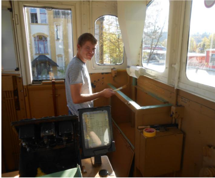
Im Schreibpult wurde bei den grundierten Stahlteilen nun ein erster Innenanstrich mit Ocker erstellt und anschließend der mit einem Zweitanstrich und neuer Rückplatte versehene hölzerne Innenkasten eingebaut und die Abdeckplatte wieder aufgeschraubt.
