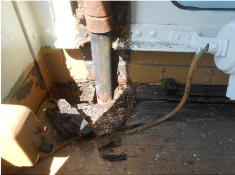
...wird der Schaden in der von der Feuchtigkeit durchfaulten Abdeckplatte des Schreibpultes erst so richtig sichtbar. Und dabei zeigte sich auch, dass das ölummantelte HS-Kabel seinerzeit nicht etwa abgerissen ...
