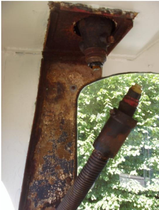
....sondern offenbar bereits 1977/78 vom AW München-Freimann feinsäuberlich durchtrennt worden war, um selbst bei gehobenem Dachstromabnehmer einen weiteren Zutritt von Hochspannung in die seit damals nicht mehr betriebsfähig abgestellte und teilausgeräumte Lok zu unterbinden.
