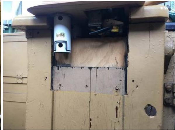
Fünf passende Originalbauteile von einer anderen zerlegten Lok (Indusi Wachsam, Frei, Befehl -Taster + Leuchtmelder M blau 65 und gelb als Leihgabe wurden auf einem Holzbrettchen für den bevorstehenden Tag des offenen Denkmals zunächst provisorisch eingepasst.
